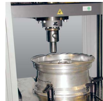
图3: 轮毂边缘轴向变形测试
