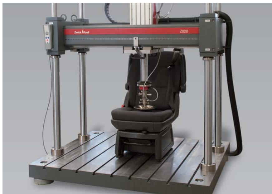
图2: 可灵活配置的试验台用于座椅特性测试
