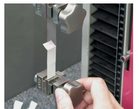
图7: 粘胶带的剥离试验
