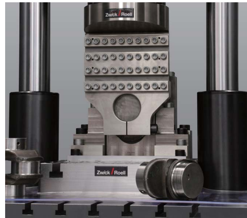
图2: 高频疲劳试验机Vibrophore对曲轴不同部位施加动态载荷
