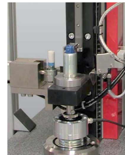
图1: 电磁阀阀体测试
