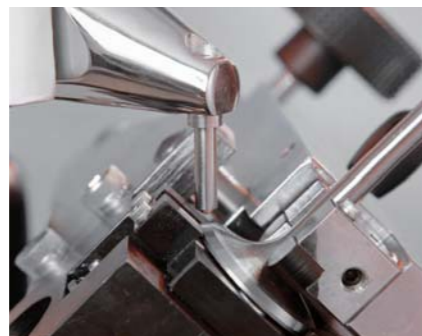
图5: 阀门硬度测试
