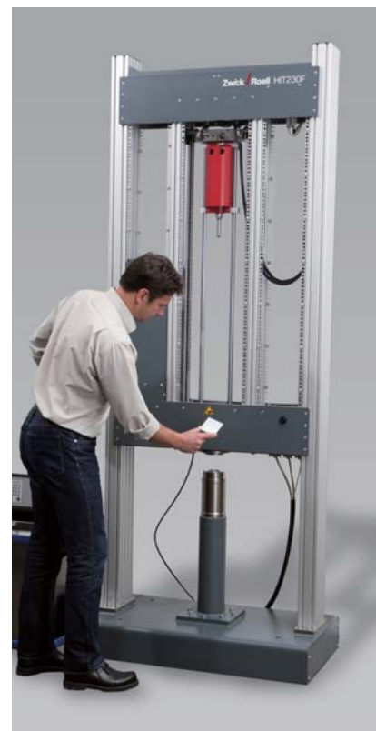
图2: HIT230F落锤冲击试验机
