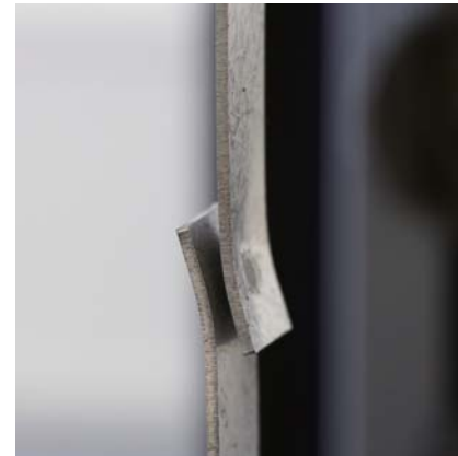
图1: 焊接试样焊点剪切强度试验
