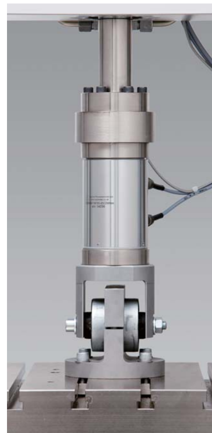
图3: 橡胶-金属减震器的测试
