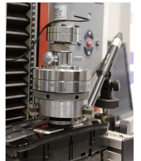
图3: 多功能旋转开关的声响和触觉测试
