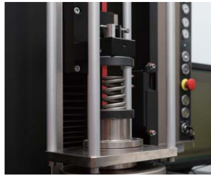
图4: 阀门弹簧测试
