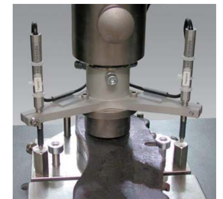
图5: 制动盘的压缩测试
