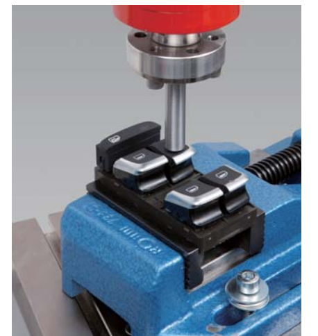
图2: 车窗升降开关的功能测试
