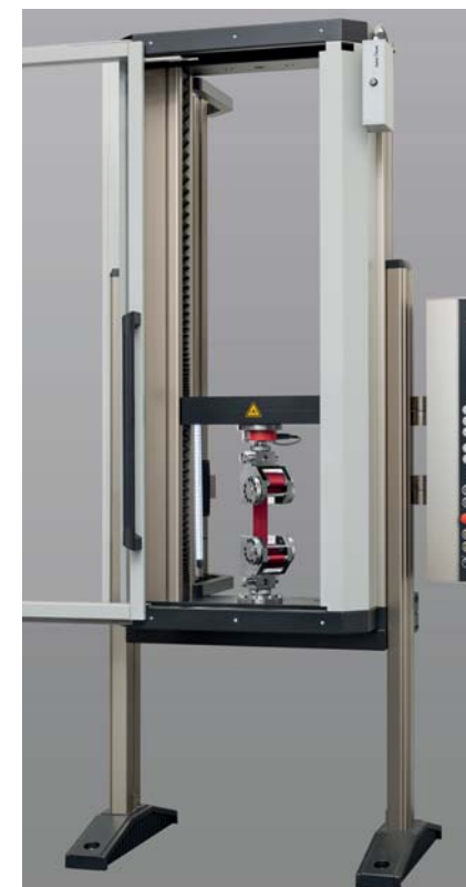
图1: 安全带拉伸测试
