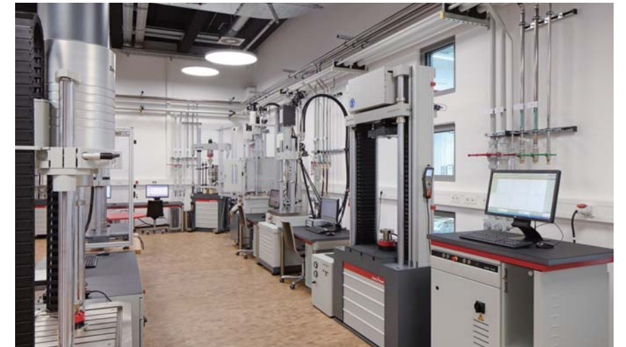
图2: 实验室中材料和部件测试的部分动态试验机
