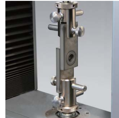
图3: 铆接试样的剪切强度试验
