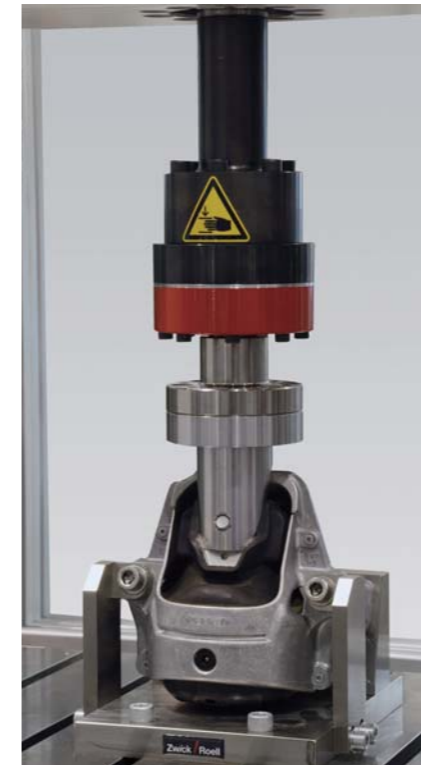
图1: 发动机安装部件进行单轴疲劳测试
