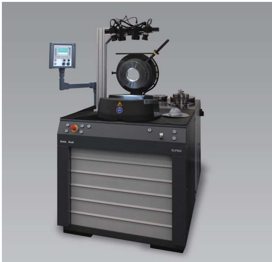
图1: BUP600金属薄板成形试验机
