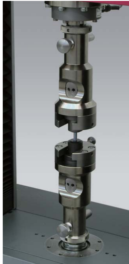
图1: 螺栓静态拉伸试验
