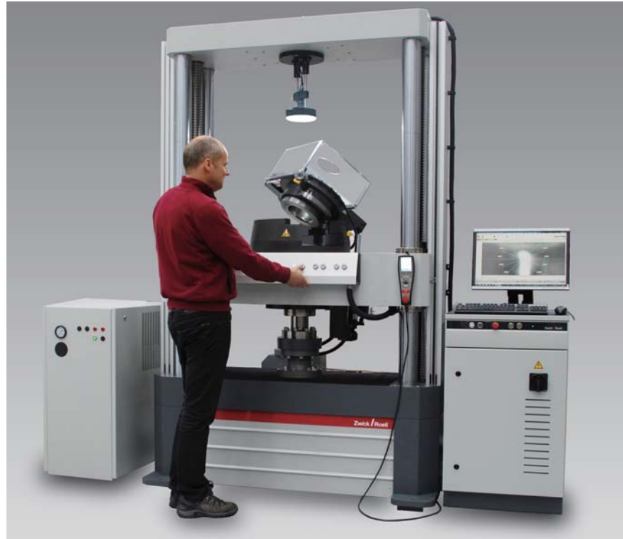
图1: 配置光学引伸计videoXtens的金属薄板试验机
