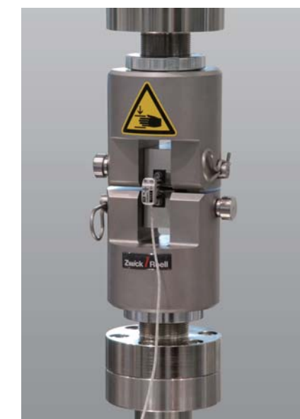
图2：断裂韧性 K_{Ic} 试验
