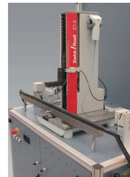
图4: 车门嵌入式传感器测试
