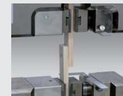
搭接木材剪切强度试验
