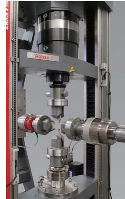
图2: 配备复合式扭转装置的双轴试验机
