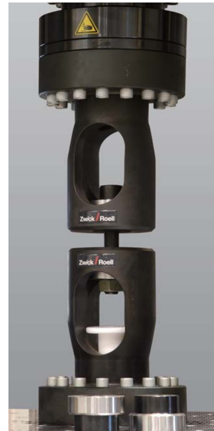
图2: 高频疲劳试验机Vibrophore 执行螺栓连接的疲劳试验
