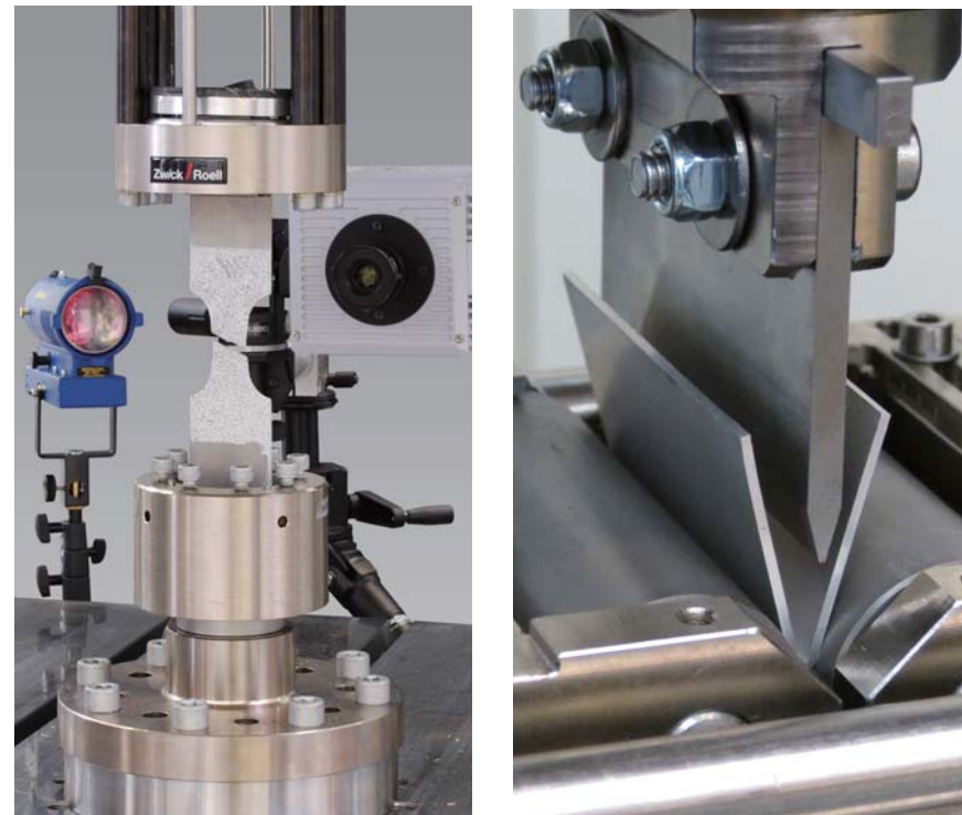
图2: 高速拉伸试验，最大拉伸速度20 m/s
