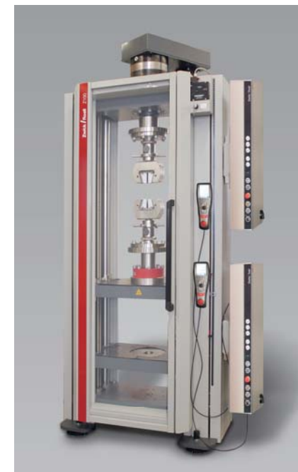
图1: 配备光学应变测量装置的拉伸-扭转试验机
