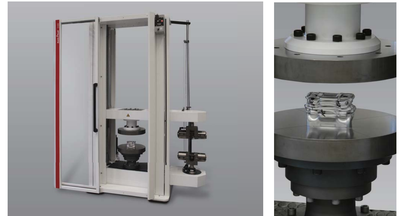
图1: AllroundLine材料试验机配置双测试空间，用于车身部件的拉伸和压缩试验
