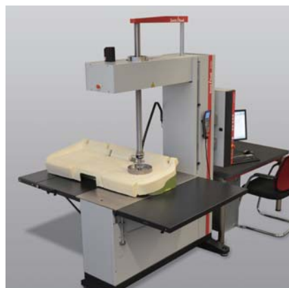
图1: 预变形的软质泡沫的压痕硬度测试
