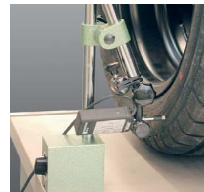
图2: 轴向、水平方向加载以及由数字式测量和控制系统testControl控制轮胎气压
