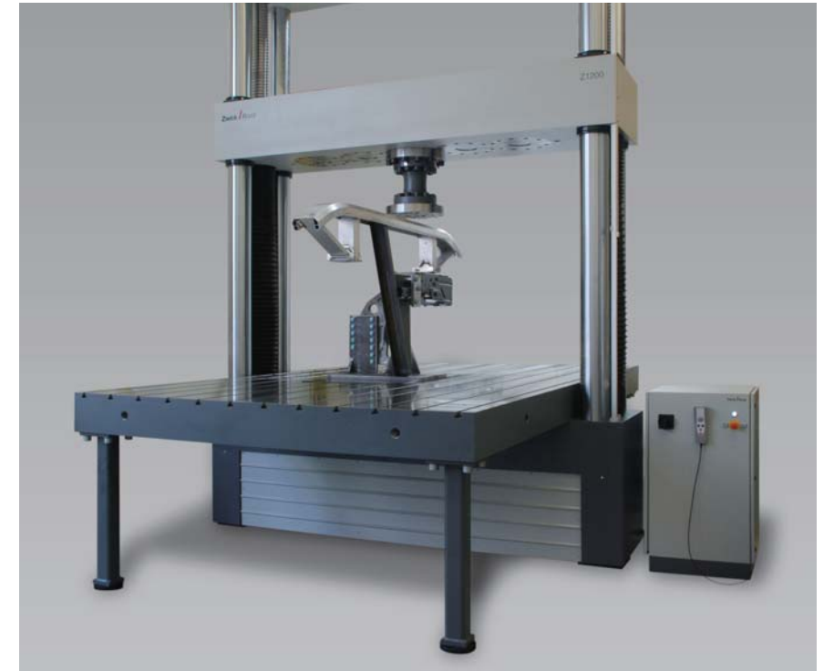
图2: 柔性夹持区域用于测试各种车身和构件部件
