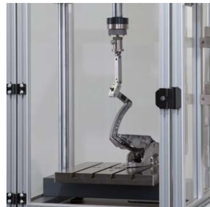
图4: 手刹车杆的疲劳试验
