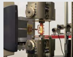
高温条件下的拉伸试验
