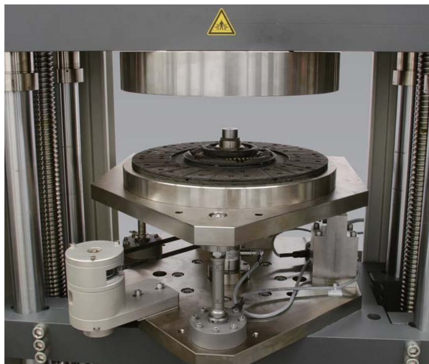
图1：探测摩擦离合器的工作压力和升程，及分离力与压盘位移关系曲线
