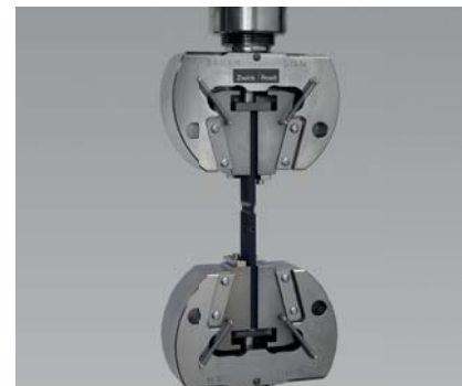
图2: 2根纤维复合材料搭接成沟槽试样的剪切试验
