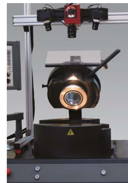
图1：薄板成形试验
