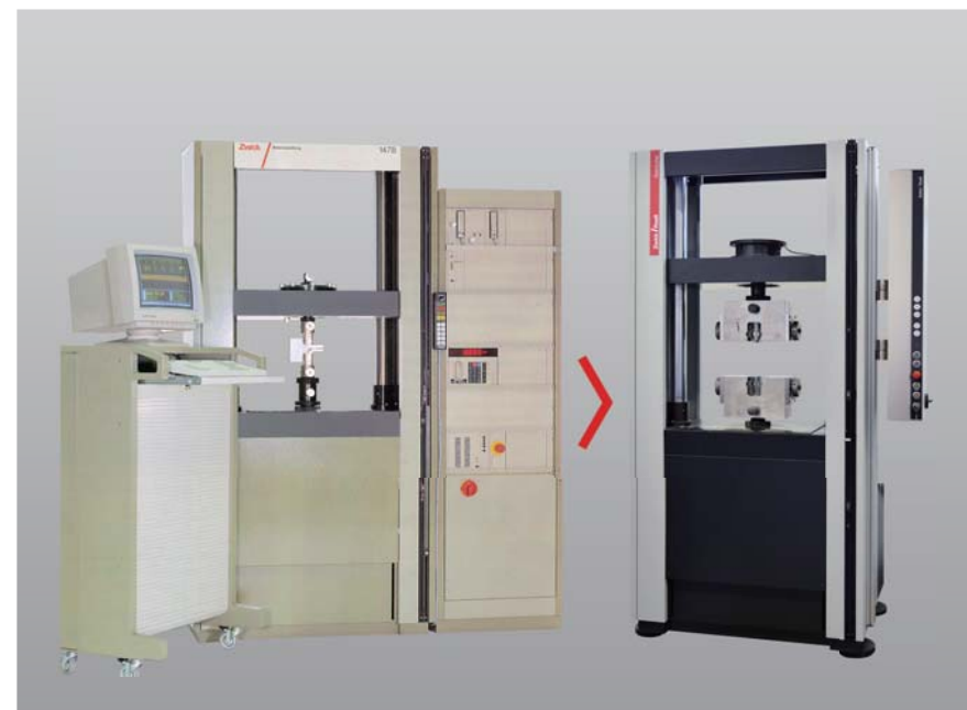
图1: 配备testControl II的静态试验机改造
